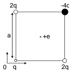
An den vier Eckpunkten eines Quadrates mit der Seitenlänge  $a$  befinden sich der Reihe nach die Ladungen  $+q, +2q, -4q, +2q$ .
