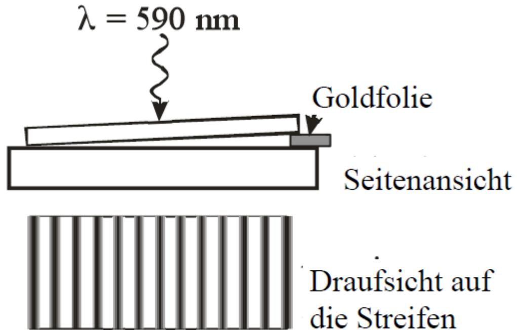
Eine Luftschicht wird realisiert, indem auf eine perfekt ebene Glasplatte eine zweite Glasplatte gelegt wird. Von dieser ist nicht bekannt, ob sie eben ist. Dann wird von oben monochromatisches Licht eingestrahlt. Aus dem hier gezeigten Streifenmuster kann man folgern, dass der Luftkeil nach rechts hin dicker wird. Wie ist die untere Oberfläche der zweiten, oberen Glasplatte beschaffen?
