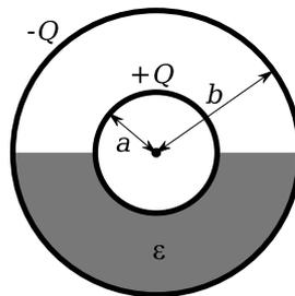
Zwei konzentrische ideal-leitende Kugelflächen mit innerem und äußerem Radius  $a$  bzw.  $b$  tragen die Ladungen  $+Q$  bzw.  $-Q$ . Der Raum zwischen den Kugelflächen sei unterhalb der Äquatorebene mit einem Dielektrikum (Dielektrizitätskonstante  $\epsilon$ ) gefüllt, während die obere Hälfte freier Raum sei.
