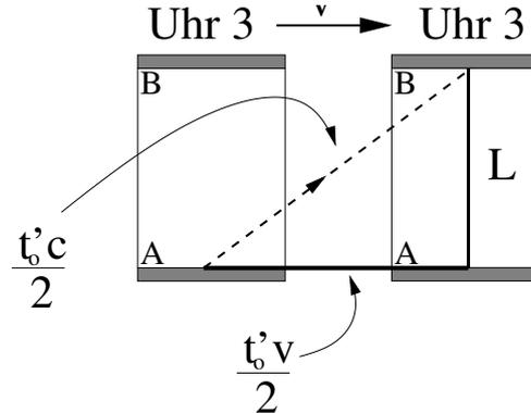
Abbildung 2: Die Uhr bewegt sich während das Licht zwischen den Spiegeln läuft.
