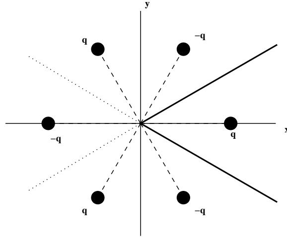
Ortsvektoren:  $\vec{x}_n = r_0 \cos \frac{2\pi n}{6} \vec{e}_x + r_0 \sin \frac{2\pi n}{6} \vec{e}_y + 0 \vec{e}_z \quad n = 0, \dots, 5.$
