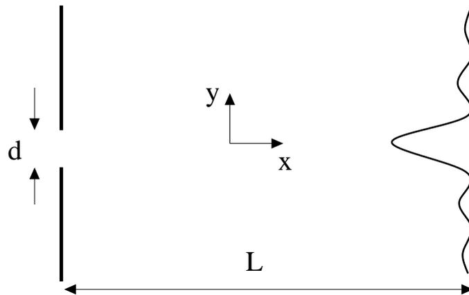
Abbildung 1: Experiment zur Beugung am Spalt.
