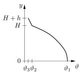
Merkmale: Der Temperaturgradient ist in der Betondecke wesentlich geringer als in der Kohlenschicht, wegen  $\lambda_{\rm B} \gg \lambda_{\rm K}$ . An der Grenzfläche hat die Temperaturverteilung einen Knick. Weiters ist die Temperaturverteilung in der Kohlenschicht parabelförmig. Wegen des adiabaten Fundamentes ist die Tangente bei y=0 senkrecht.
