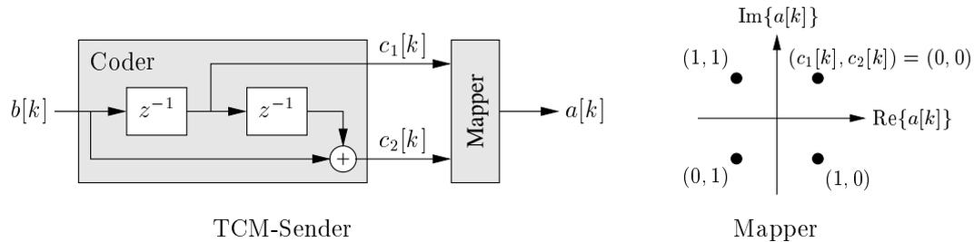
Der Faltungscodierer erzeugt aus den Sendebits  $b[k]$  in jedem Schritt zwei Codebits  $c_1[k] = b[k-1]$  und  $c_2[k] = b[k] \oplus b[k-2]$  ( $\oplus$  bezeichnet Addition modulo 2). Diese werden vom Symbol-Mapper auf die Symbole  $a[k]$  (mit  $|a[k]|^2 = 8$ ) abgebildet.
