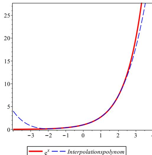
Innerhalb des Interpolationsintervalles  $[-2, 2]$  ist die Approximationsqualität sehr gut; außerhalb nimmt sie rasch ab.
