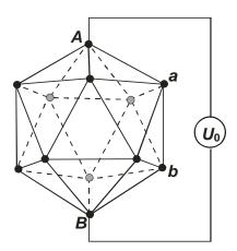
Die Knoten des Ikosaeders bilden die leitfähigen Verbindungen zwischen den Widerständen. Zwischen den genau gegenüberliegenden Knoten A und B wird eine Spannung  $U_0$  angelegt.
