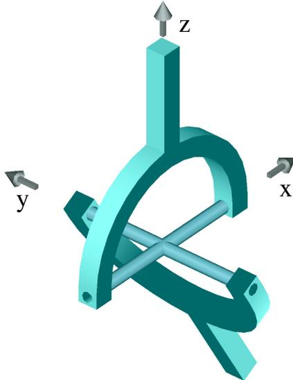
Das Kardangeln dient zur Verbindung zweier umlaufender Wellen, deren Achsen einen Winkel  $\alpha$  einschließen. Die Wellen tragen an ihren Enden je eine Gabel, die über ein starres Kreuz miteinander verbunden sind. Wir fragen nach dem Übersetzungsverhältnis, das ist das Verhältnis der (phasenabhängigen) Winkelgeschwindigkeiten  $\omega_1$  und  $\omega_2$  der Wellen.
