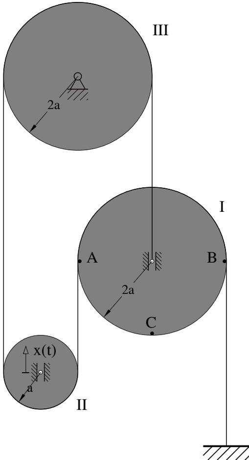
Ein undehnbares Seil wird gemäß Skizze über 3 Rollen (Radien  $2a$ ,  $a$ ,  $2a$ ) geführt und an der Achse der Rolle I fixiert. Die zwei Rollen I und II sind vertikal verschiebbar, die Rolle III fest gelagert. Die vertikale Position der Achse der Rolle II sei durch  $x(t)$  bestimmt. Man ermittle die Winkelgeschwindigkeiten im Modell und speziell den Geschwindigkeits- und Beschleunigungszustand der Rolle I.
