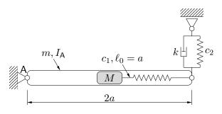
Eine Punktmasse M wird in einem Rohr (Masse m, Länge 2a, Trägheitsmoment  $I_{\mathsf{A}}$  um den Lagerpunkt A) reibungsfrei geführt. Zwischen Masse und Rohrende wirkt eine Feder (Federsteifigkeit  $c_1$ , ungedehnte Länge  $\ell_0 = a$ ). Das Rohr ist im Punkt A frei drehbar gelagert und am anderen Ende mit einem Feder-Dämpfer-System (Parameter:  $c_2$ , k) verbunden. Das Feder-Dämpfer-
