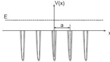
Das **Blochtheorem**, welches für **periodische Potentiale** gilt, besagt, dass die Energieeigenfunktionen eines Teilchens durch einen **kontinuierlichen Parameter  $K$** ,  $K \in \left[-\frac{\pi}{a}, \frac{\pi}{a}\right]$ , die sogenannte **Quasiwellenzahl**, gekennzeichnet werden können. Für die zu einem gegebenen  $K$  gehörige Energieeigenfunktion gilt  $\psi_K(x+l \cdot a) = e^{iK \cdot l \cdot a} \cdot \psi_K(x)$ ,  $l = 0, \pm 1, \pm 2, \dots$ .
