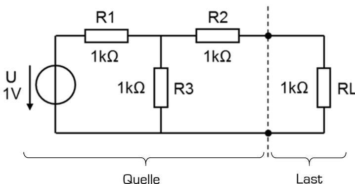
Berechnen Sie den Spannungsabfall am Lastwiderstand RL mit der Spannungsteilerregel.
