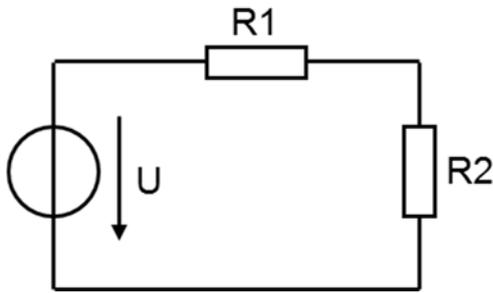
Bei welchem Wert von R2 erreicht die Leistung ein Maximum, wenn  $R1 = 100 \Omega$  und R2 verändert wird. (Leistungsanpassung!)
