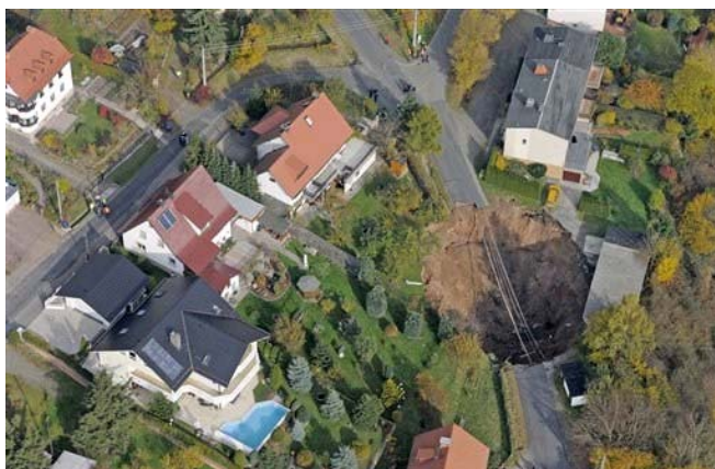
Abb. 16: Erdfall von Schmalkalden in Thüringen der durch Gipslösungsprozesse im Untergrund verursacht wurde (aus: http://news.de.msn.com/panorama/bilder.aspx?cp-documentid=155141066&page=9 )
