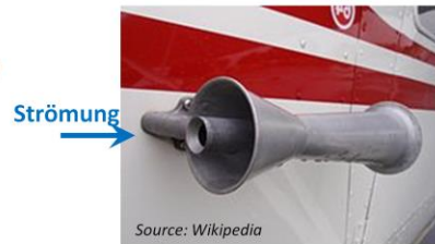
Venturirohr am Rumpf eines Flugzeugs für Geschwindigkeitsmessung
