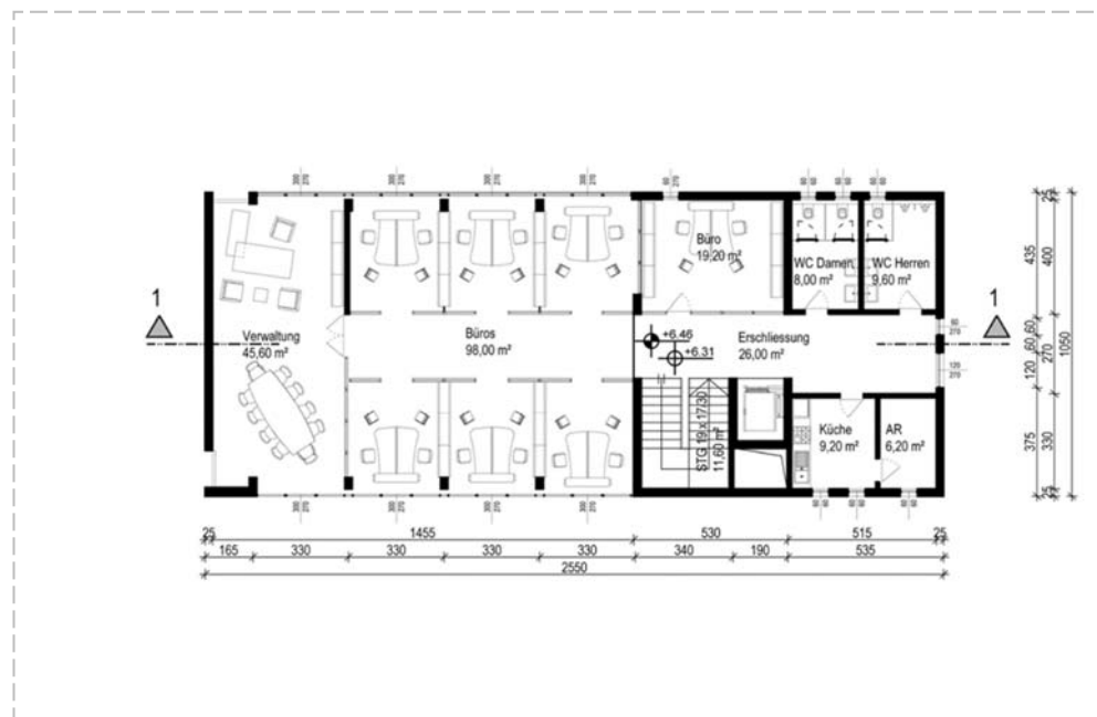
Abbildung 4: Entwurfsplan Regelgeschoß, M 1:200
