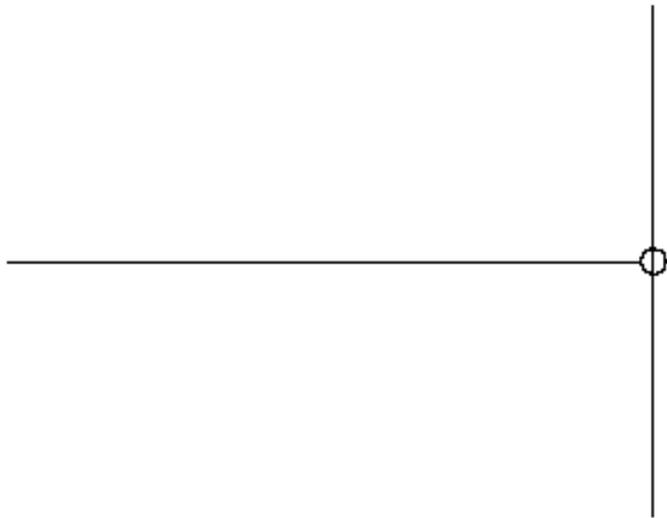
Hier kann das Schnurende die Schwingung unbehindert mitmachen und es wird von der Grenze keine vertikale Kraft übertragen. So hat die rücklaufende Welle keine Phasenverschiebung.
