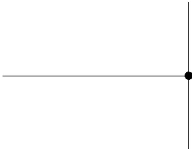
Da das Ende fixiert ist und keine Bewegung ausführen kann, wird nach dem dritten newtonschen Gesetz eine gleich große Kraft nach unten auf die Schnur ausgeübt und erzeugt eine gegenläufige Welle mit einer Phasenverschiebung von  $180^\circ$ .
