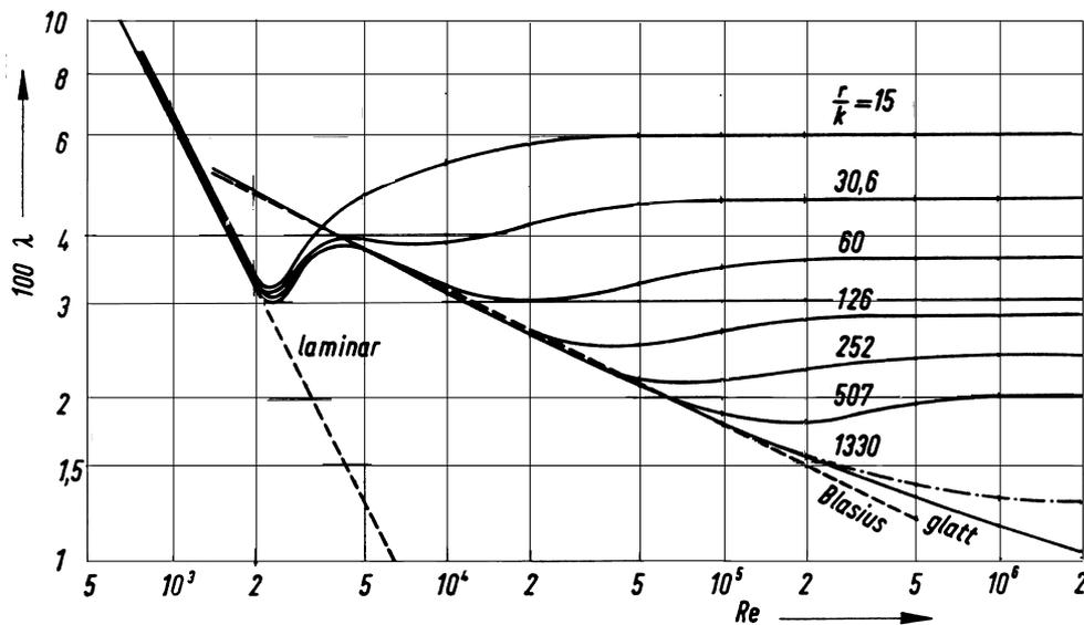
**Bild 4.51** Widerstandszahl  $\lambda$  von rauhen Rohren; abhängig von der Reynoldsschen Zahl, nach Nikuradse (ausgezogen) und Bauer und Galavics (strichpunktiert)
