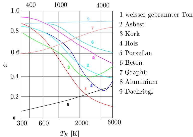
Abhängigkeit des Gesamtabsorptionsvermögens  $\bar{\alpha}$  verschiedener Oberflächen der Temperatur  $T_0 = 300$  K für Strahlung, die von einer grauen Oberfläche der Temperatur  $T_R$  emittiert wird.
