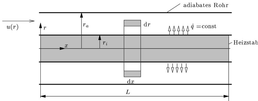
In einem von einer Newtonschen Flüssigkeit durchströmten Zylinderrohr befindet sich ein koaxialer Heizstab, der eine auf die Heizfläche bezogene, konstante Heizleistung  $q$  abgibt. Berechnen Sie für das gegebene Rohr die Geschwindigkeitsverteilung  $u(r)$  für eine vollausbildete laminare, stationäre Strömung.
