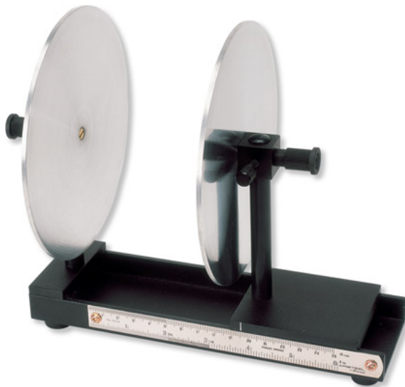
Abb. 3: Plattenkondensator mit variablem Luftspalt
