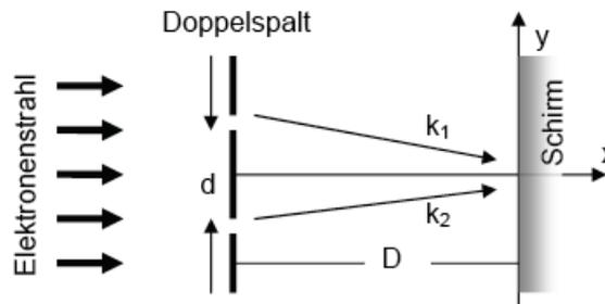
Ein Strahl von Elektronen wird an einem Doppelspalt gebeugt und trifft bei  $x=0$  auf einen Schirm, der die auftreffenden Elektronen registriert. Die Energie der Elektronen beträgt 150 eV. In der Nähe der Schirmmitte können die beiden Partial-Wellen  $\Psi_1$  und  $\Psi_2$ , welche von den beiden Schlitzen ausgesandt werden, durch ebene Wellen gleicher Amplitude  $A$  (aber mit unterschiedlichen Wellenvektoren) angenähert werden:
