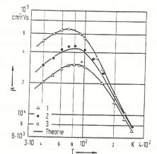
Eine GaAs-Probe mit einer Donatorkonzentration von  $N_D$ = 5.4·10<sup>15</sup> cm<sup>-3</sup> hat eine Elektronenbeweglichkeit von  $\mu_{nI}$  = 20000 cm<sup>2</sup>/(V·s) bei T<sub>1</sub>=40K und eine Elektronenbeweglichkeit von  $\mu_{n2}$  = 8000 cm<sup>2</sup>/(V·s) bei T<sub>2</sub> = 300K.
