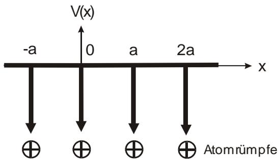
Das Potential der Rumpfatome im Halbleiterkristall kann durch ein einfaches periodisches Potential angenähert werden. Diskutieren Sie die Bandstruktur eines eindimensionalen Kristallgitters anhand des periodischen Delta-Potentials:
