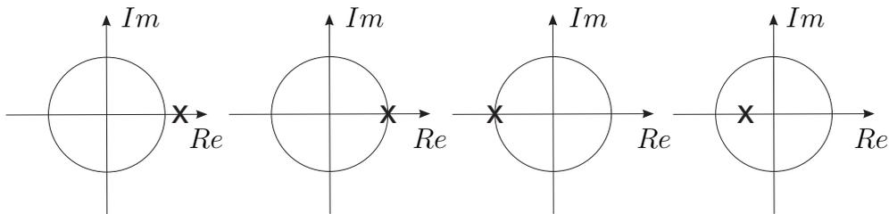
Abbildung 2: Eigenwerte eines Abtastsystems
