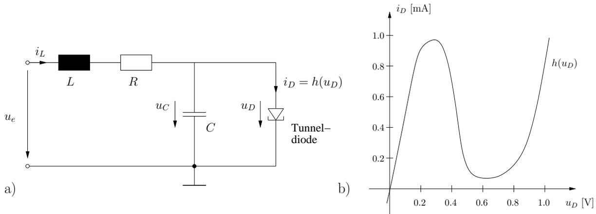
Abbildung 1: a) Schaltkreis mit Tunneldiode und b) zugehörige nichtlineare Stromcharakteristik  $i_D = h(u_D)$ .
