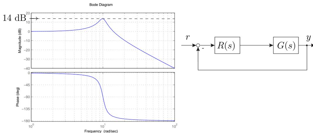
Abbildung 3: Bodediagramm des geschlossenen Kreises und Struktur des Standardregelkreises
