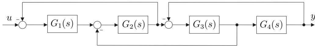
Abbildung 2: Zusammenschaltung von Übertragungsfunktionen.
