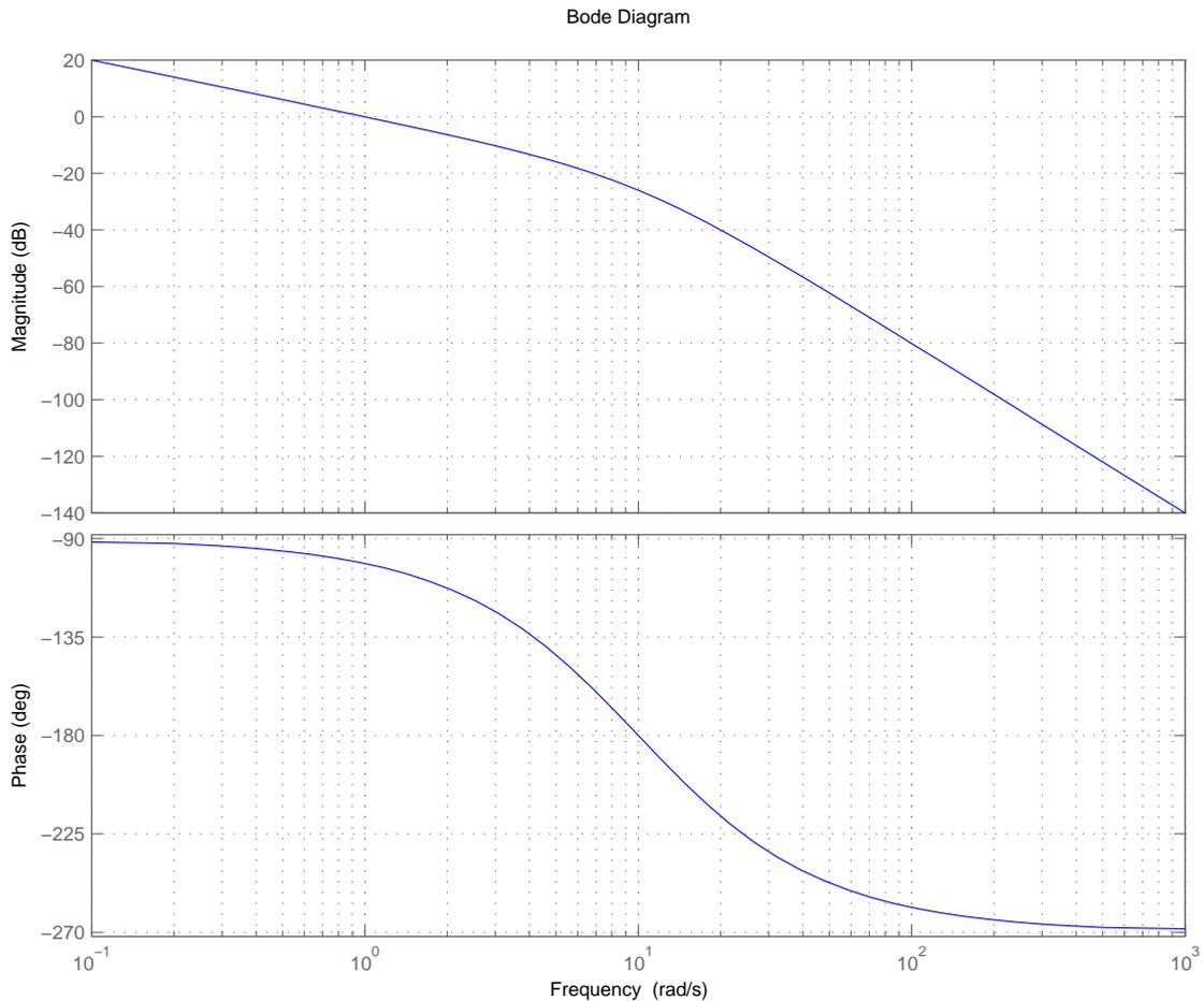
Abbildung 4: Bodediagramm der Strecke  $G(s)$
