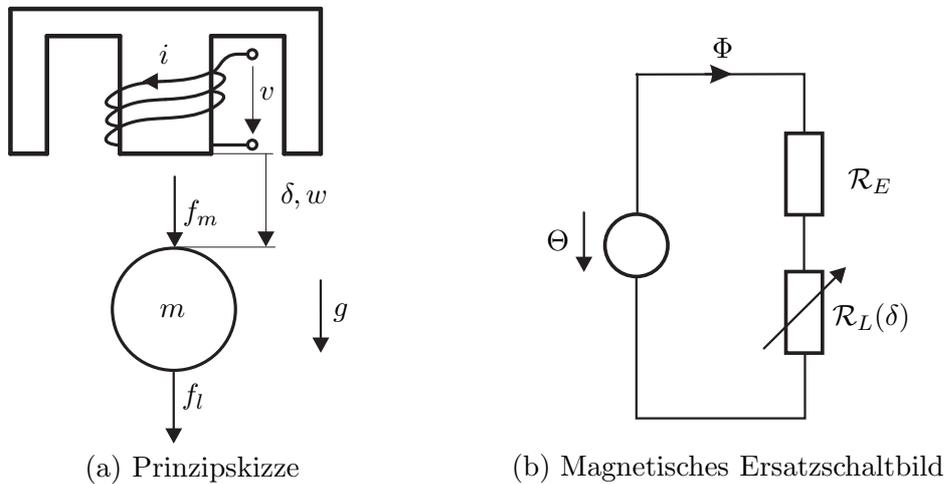
Abbildung 1: Prinzipskizze der eindimensionalen Magnetlagerung und magnetisches Ersatzschaltbild.
