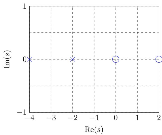
Abbildung 3: Pol-Nullstellen Diagramm eines zeitkontinuierlichen LTI-Systems.
