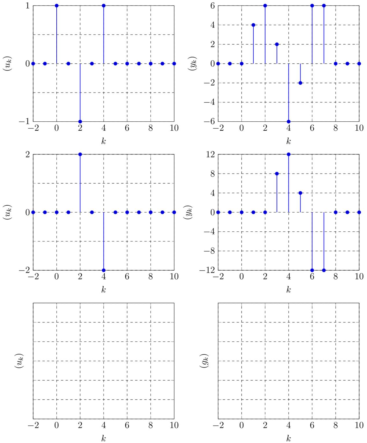
Abbildung 2: Eingangs-Ausgangsverhalten eines zeitdiskreten LTI-Systems.
