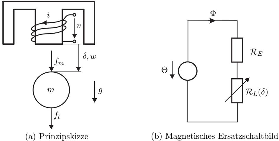
Abbildung 1: Prinzipskizze der eindimensionalen Magnetlagerung und magnetisches Ersatzschaltbild.
