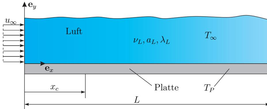
Abbildung 3: Konvektion an einer ebenen Platte
