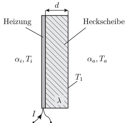
Abbildung 1: Heckscheibe mit Heizung.
