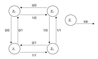
Ändert sich der Zustand des Eingangssignals s nicht, so pendelt der Automat immer zwischen den Zuständen  $Z_0 \leftrightarrow Z_1$  bzw.  $Z_2 \leftrightarrow Z_3$  hin und her und ändert dabei den Zustand des Ausgangs p. Ändert sich hingegen der Zustand von s, so wechselt der Automat zwischen den Zuständen  $Z_0 \leftrightarrow Z_2$  bzw.  $Z_1 \leftrightarrow Z_3$  und p ändert sich bei diesem Übergang nicht.
