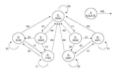
Die linke Seite des Zustandsgraphen ist für den Ausgangskanal 0, die rechte Seite des Zustandsgraphen ist für den Ausgangskanal 1 zuständig. Um jenen Fehlerfall zu berücksichtigen, daß überhaupt nur ein Adreßbit übertragen wird, ist der Zustandsgraph durch die Übergänge  $Z_1 \rightarrow Z_0$  und  $Z_4 \rightarrow Z_0$  zu ergänzen.
