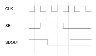
Nach dem Aktivieren des Scan-Modus durch SE = 1 werden mit den nächsten 2 positiven Taktflanken die Ausgänge der niederwertigen Flip-Flops in SDOUT geschoben. Aus den anliegenden Werten  $1 \to 0 \to 0$ , welche den Zustandsvariablen  $Q_2^n = 1$ ,  $Q_1^n = 0$  und  $Q_0^n = 0$  entsprechen, läßt sich somit der Zustand bestimmen, in dem sich der Automat vor dem Aktivieren von SE = 1 befunden hat. Nach der in Beispiel 2.3 gewählten Codierung entspricht dieser Zustandsvektor dem Zustand c.
