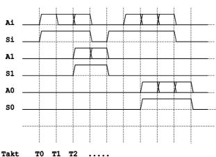
Alle drei Kanäle bestehen jeweils aus einer A-Leitung und einer S-Leitung. Auf den A-Leitungen werden die Daten seriell übertragen. Die S-Leitungen sind während der Datenübertragung high und
