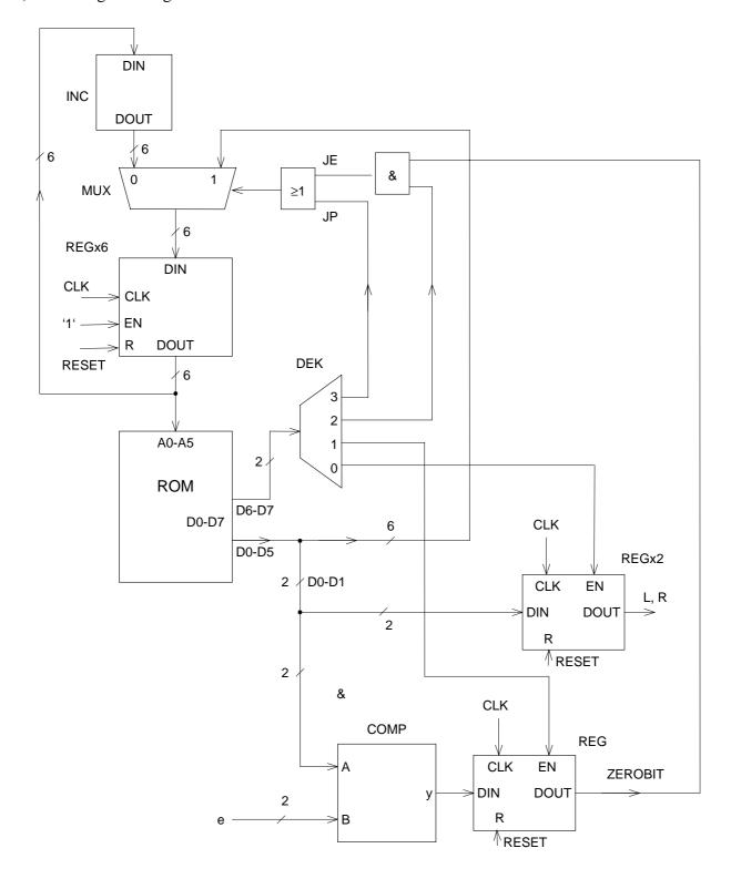
Die Resetleitung setzt alle 3 Register bei einem Reset auf 0. Damit sind die Ausgänge L und R nach Inbetriebnahme 0 und der Programmzähler wird auf Adresse 0 gesetzt.
