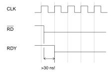
In vorliegendem Fall kommt die fallende Flanke des /RD-Signals kurz nach der steigenden Flanke des Taktsignals CLK. Nachdem sich Ausgangssignale von Moore-Automaten aber nur zu Beginn jedes Zustands ändern können, würde das RDY-Signal vom Automaten hier zu spät, nämlich im Extremfall erst 100 ns nach der fallenden Flanke von /RD auf 0 gesetzt werden.
