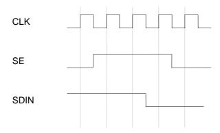
Nach dem Aktivieren des Scan-Modus durch SE=1 werden mit den nächsten 3 positiven Taktflanken die an SDIN anliegenden Werte  $1 \to 1 \to 0$  in die Flip-Flops geladen. Damit befindet sich der Automat in jenem Zustand, welcher durch die Zustandsvariablen  $Q_2^n=1$ ,  $Q_1^n=1$  und  $Q_0^n=0$  bestimmt ist. Nach der in Beispiel 2.3 gewählten Codierung entspricht dies dem Zustand e.
