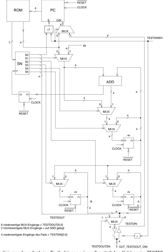
Zur Realisierung der geforderten Testfunktionen mit nur 2 zusätzlichen Gehäusepins TESTDINEN (Test Data In) und TESTDOUTEN (Test Data Out Enable) werden die 8 Pins des Ports OUT (4
