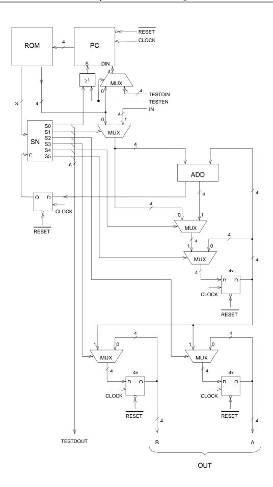
Damit die Ausgangssignale des Schaltnetzes SN außerhalb des Chips sichtbar sind, werden diese einfach an 6 der bisher nicht belegten Gehäusepins des Chips geführt (Signalvektor TESTDOUT[5:0]). Damit wird die Beobachtbarkeit der Schaltung erhöht.
