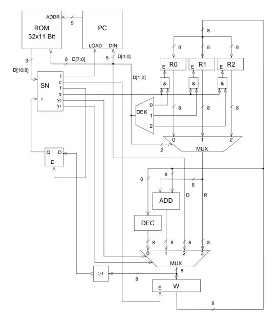
Das globale Taktsignal C und das globale Resetsignal wurden der Einfachheit halber ausnahmsweise nicht in die obige Schaltung eingezeichnet. Von C werden sowohl der Program Counter PC als auch das Register für das Zero-Flag und die Register W, R0, R1 und R2 getaktet. Alle Register und der Program Counter können über das globale Resetsignal resetiert werden.
