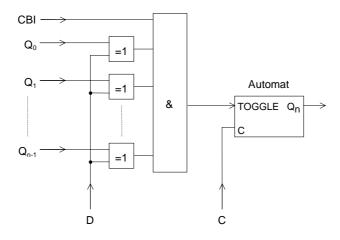
Der Automat ändert den Zustand an seinem Ausgang  $Q_n$  wenn der Eingang TOGGLE = 1 ist und behält bei TOGGLE = 0 den Zustand von  $Q_n$  bei. Über die EXOR-Gatter können beim Rückwärtszählen mit D=1 die Eingänge  $Q_0,\,Q_1,\,Q_2,\,...\,Q_{n-1}$  invertiert werden. Damit die Zählstufe nur bei CBI = 1 weiterzählt, wird CBI in die UND-Verknüpfung miteinbezogen.
