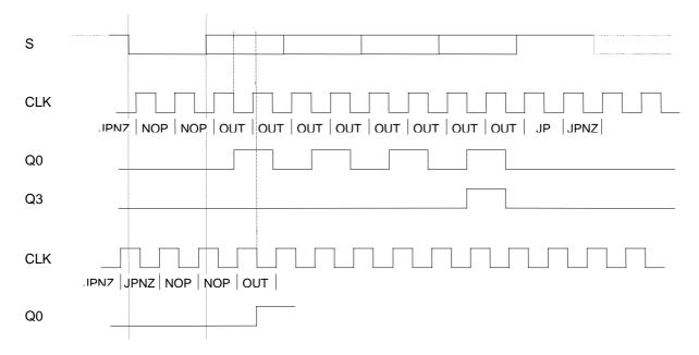
In obigem Timing sind nun wieder die beiden Extremfälle für die Phasenlage des Taktes CLK zum Signal S dargestellt. Wie zu sehen ist, erfolgt das Takten des Schieberegisters SR im ersten Fall bei 25% der Bitdauer, während im zweiten Fall das Schieberegister bei 75% der Bitdauer getaktet wird. Das Zeitpunkt des Einlesen des seriellen Bitstroms von S liegt damit gerade im erlaubten Toleranzbereich.
