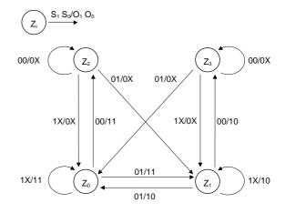
Zur besseren Verdeutlichung wurde der Zustandsgraph zweimal gezeichnet. Im linken Bild wurden die Werte D, 0 und 1 für {S0, S1} sowie 0, -1 und +1 für {O0, O1} direkt in den Graphen eingezeichnet, während im rechten Bild die binär codierten Werte für {S0, S1} und {O0, O1} angegeben sind.
