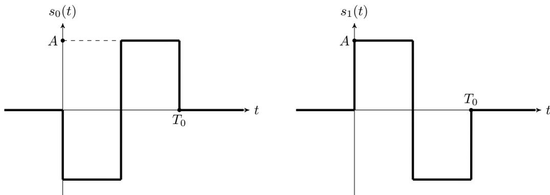
Abbildung 2: Manchester-codierte Sendesignale  $s_0(t)$  und  $s_1(t)$  aus Beispiel 11.
